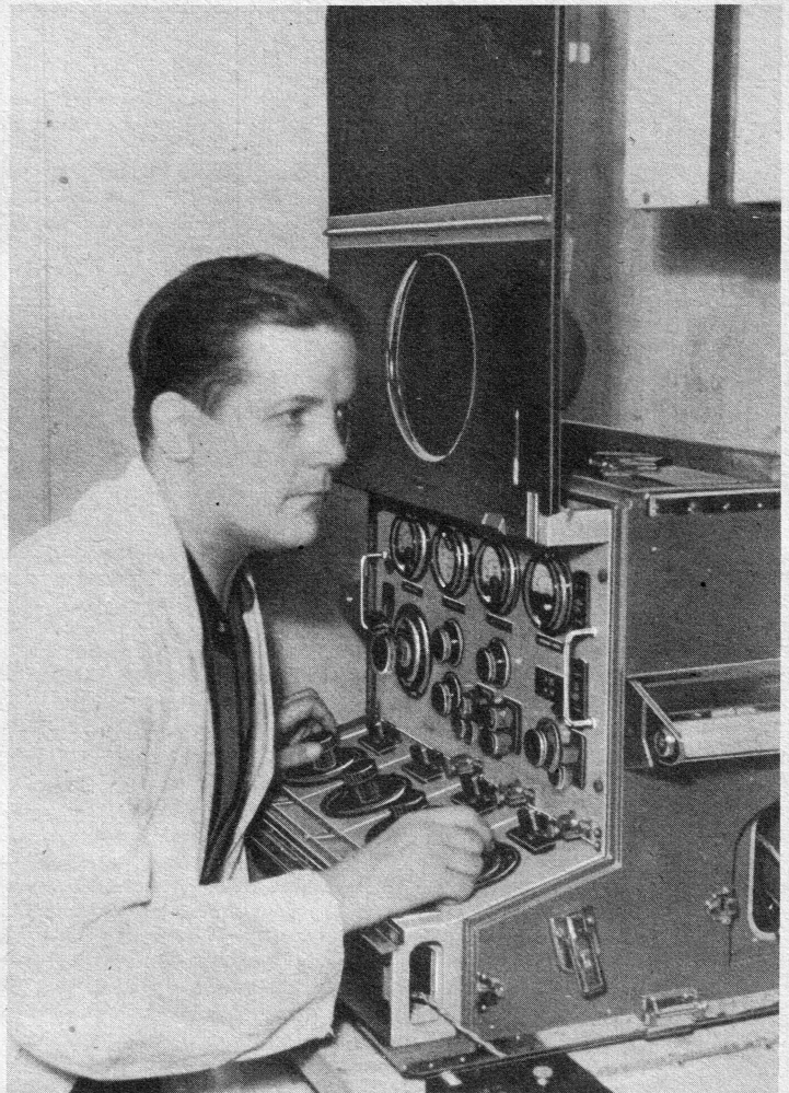
Das auf der Winterolympiade bereits angewandte und bewährte Aussteuerungs-Überwachungsgerät mit Mischeinrichtung, eingebautem Mikrophonverstärker und Abhörlautsprecher findet auch in Berlin wieder Verwendung. (Sämtliche Aufnahmen Michaelis)
